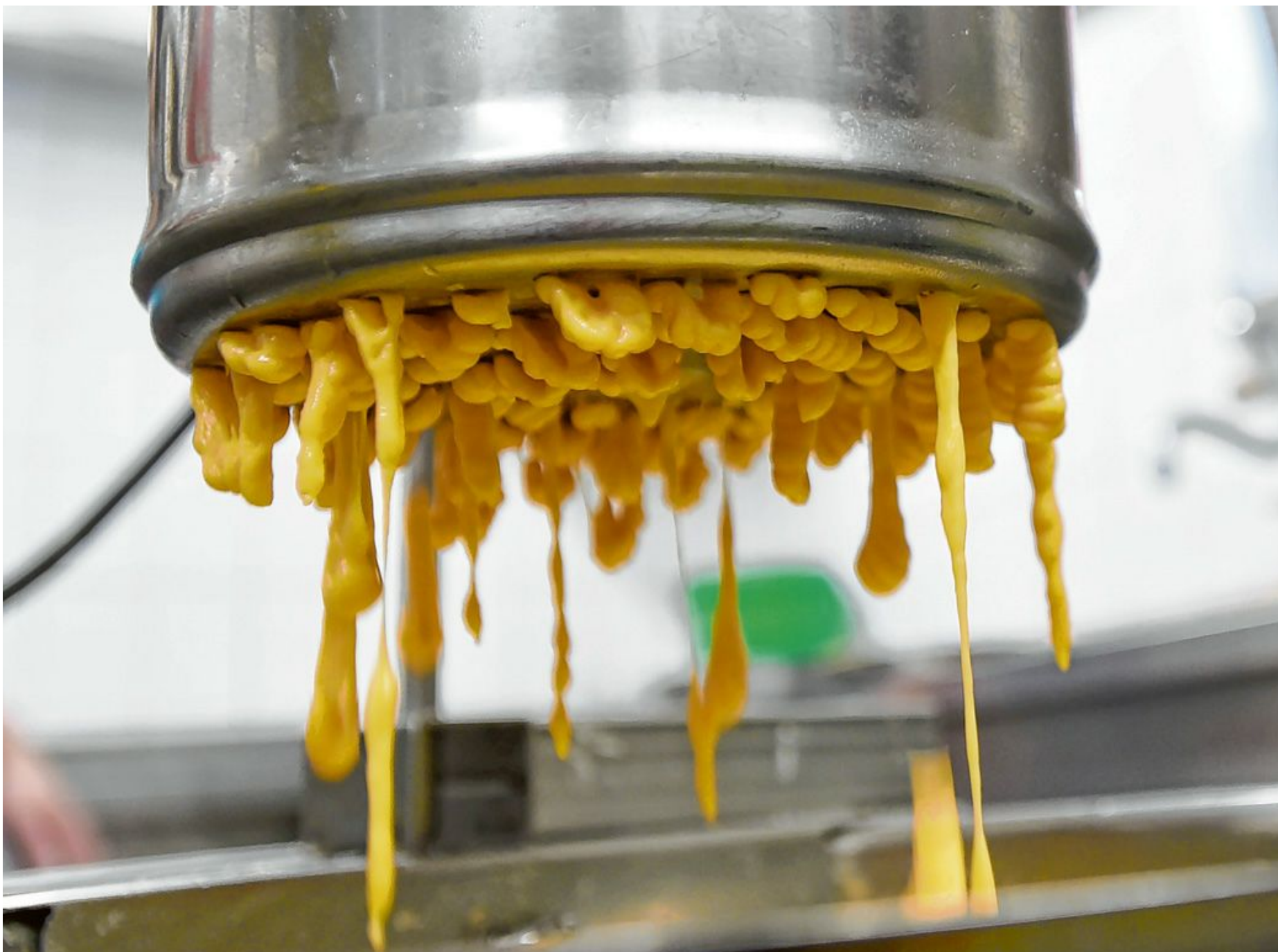
Die Zeiten des manuellen Spätzlehobels sind auf dem Frischhof in Königsbrunn seit etwa 20 Jahren vorbei. Heute wird der Teil in eine Maschine gegeben, die selbstständig die typische Spätzleform fabriziert und sie ins kochende Wasser gleiten lässt. Fotos: Marcus Merk
